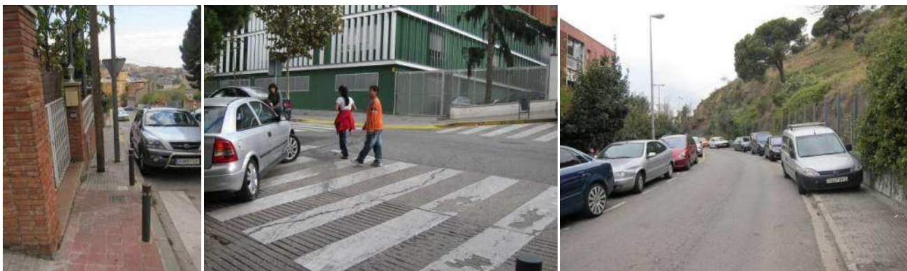
Figura 3.6: Exemple de problemes habituals per vianants al municipi: Voreta inaccessible degut de pilones al gual i obstacles a la vorera (esquerra), fora d'una escola sobre un pas de vianants (centre) i cotxes aparcats sobre la vorera (dreta).
