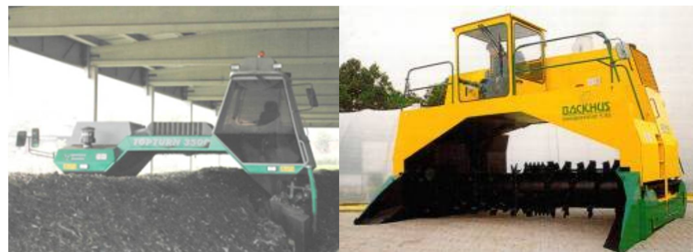
Voltejadores de piles
