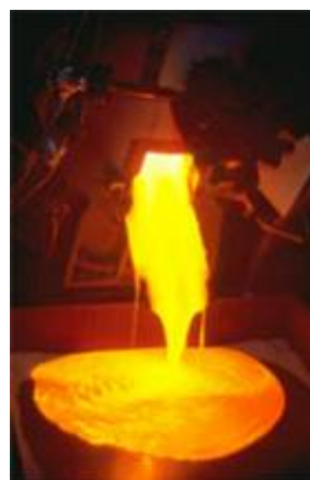
Figura 60: Extracció d'escòries foses del reactor de gasificació.
