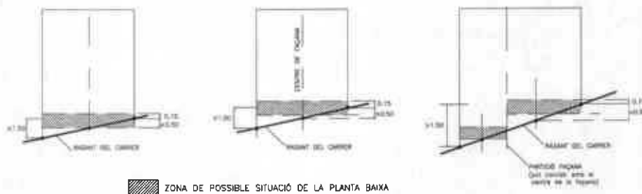
Croquis núm. 2 DETERMINACIÓ DEL NIVELL DE LA PLANTA BAIXA
